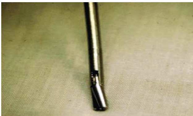
Figura 1: ruptura de pinza Grasper.
